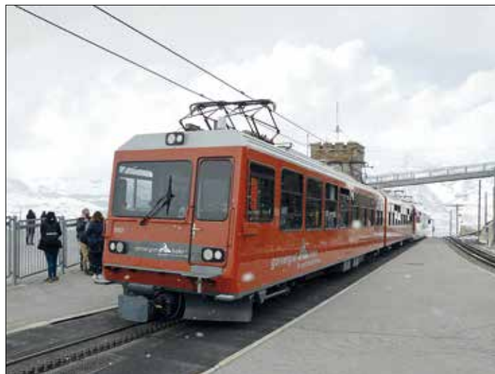
Ci-dessus : avec des rampes de 20 % et des courbes à angle droit, la Gornergrat Bahn bat des records. La ligne est parfaitement entretenue et les interventions du personnel sont fréquentes (12 juin 2019).
